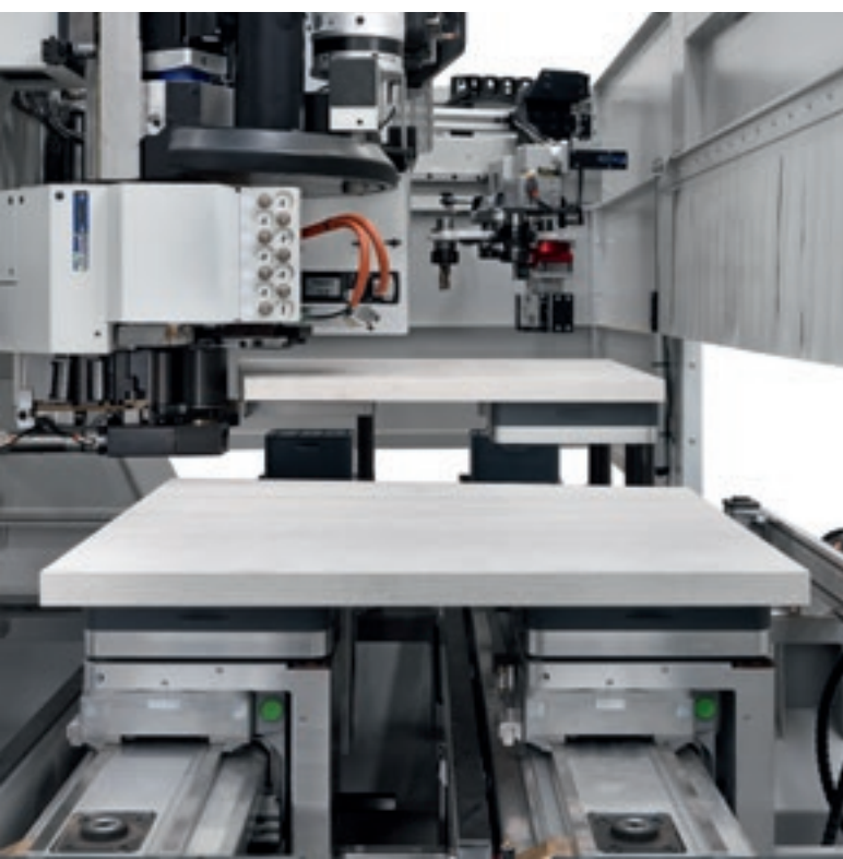
Systèmes de blocage pneumatique Uniclamp et Hyperclamp à détachement rapide pour des blocages rigides et précis.
